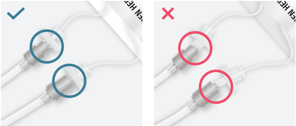
ABBILDUNG 16: Links: korrekte Verbindung der Luer-Anschlüsse zwischen Sonde und Verbindungsschlauch. Rechts: schiefe oder unvollständige Verbindung der Luer-Anschlüsse kann zu Undichtheiten führen.
